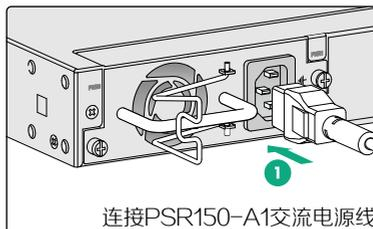
连接PSR150-A1交流电源线
